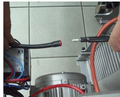
3 - Отсоединить кабель электрода ионизации от разъема;
