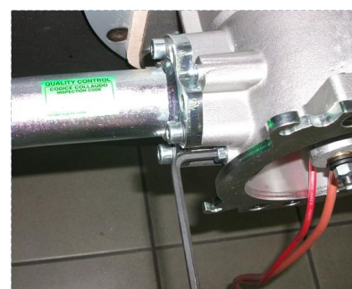
6 - Отвинтить 2 винта см. рис.6-7;
