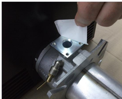
2 - повернуть Горелка и Снять заглушку;
