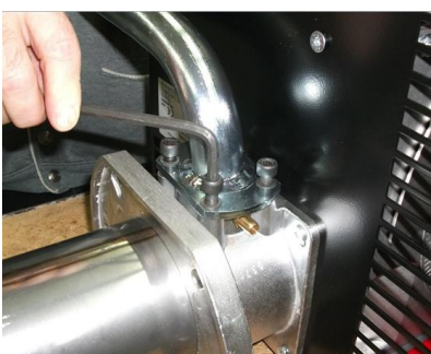
4 - Прикрепить Труба ГАЗОВОЙ рампы в фланец при помощи 4-х винтов с цилиндрической головкой;
