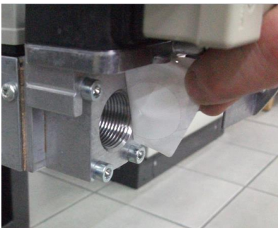
7 - Снять заглушку из Труба ГАЗОВОЙ рампы;
