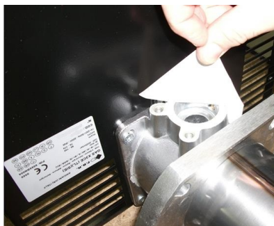
2 - повернуть Горелка и Снять заглушку;
