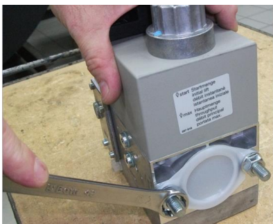
8 - Снять заглушку из электроклапан;
