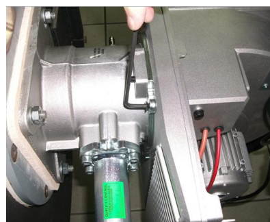
4 - Снять смесительный узел горелки ослабив 4 винта и поворачивать узел до снятия с винтов;
