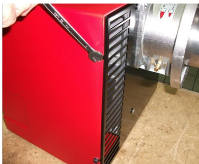
1 - Снять кожух, ослабив 4 винта;
