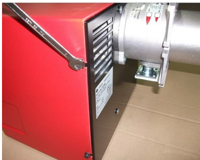
1 - Снять кожух, ослабьте 4 винта;
