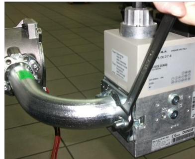
8 - установить электроклапан и Прикрепить из фланец;
