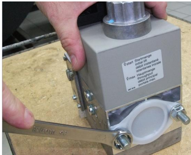
7 - Снять заглушку из электроклапан;
