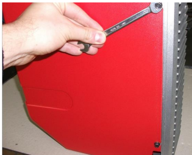
1 - Снять кожух, ослабив 4 винта;
