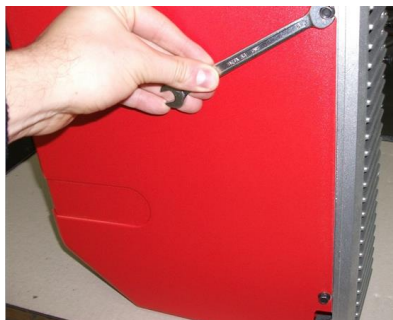
10 - Снять кожух, ослабив 4 винта;
